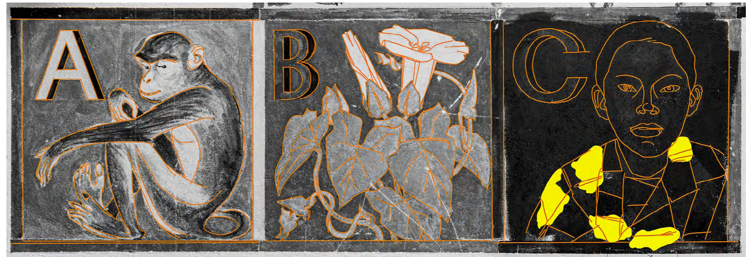
Abb. 4: Kartierung der Bildfelder A, B und C. Orange: Ritzungen. Gelb: Kittungen. © Carmen Hiltbrunner, HKB
